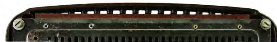
Bild 6. Die Rückwand von Verlagerungsgeräten, die auf dem Typ 208U (alt) basieren, ist am oberen Rand mit einem Pertinax-Streifen versehen. Diesen findet man nicht bei den ursprünglichen Philips-Modellen 203U, 204U, 208U und darauf basierenden Geräten.
