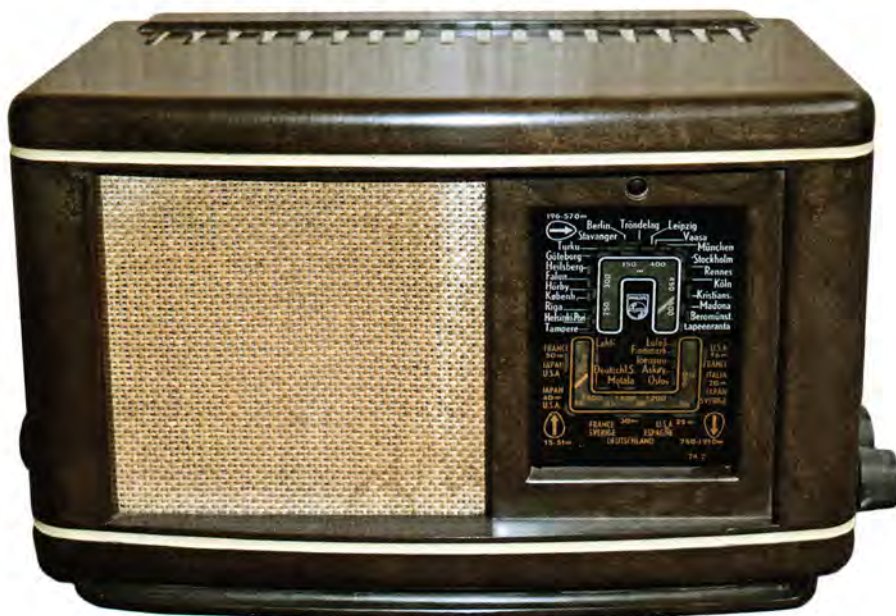
Bild 3. Philips 208U-48, eine der ersten Ausführungen des Philips 208U, worauf Verlagerungsgeräte basierten. Spätere Ausführungen des 208U haben ein anderes Gehäuse und keine farbige Abstimmkala mehr. Für die 208U-Verlagerungsgeräte wurden allerdings abweichende Gehäuse verwendet. Siehe Text. Bild: Ronald van Apeldoorn (NL)
