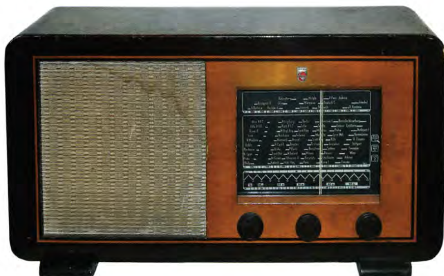
Bild 8. Batterie-Gerät Philips 611B, auf dem vermutlich Verlagerungsgeräte basierten. Bild: Jean-Louis Heyd (F)
