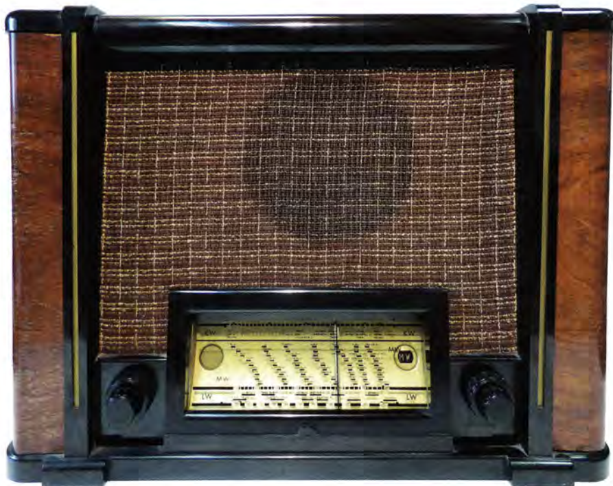
Bild 14. Opta Radio (Löwe) 156W, Verlagerungsgerät basierend auf dem Philips A52A (Frankreich). Es handelt sich hier um eine Ausführung „150“, vermutlich für Zielland Bulgarien und/oder Rumänien mit einer Netzspannung von 150 V. Das goldfarbige Typschild befindet sich auf dem Chassis, das Schild von Opta Radio auf der Rückwand. Bild: Reinhard Hopfe
