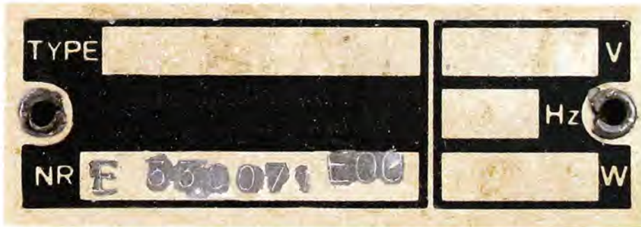
Bild 5. Die meisten Schilder mit Gerätenummern sind „goldfarbig“. Es gibt aber auch die von Philips bekannten schwarz-weißen Schilder (jedoch ohne den Namen Philips).
